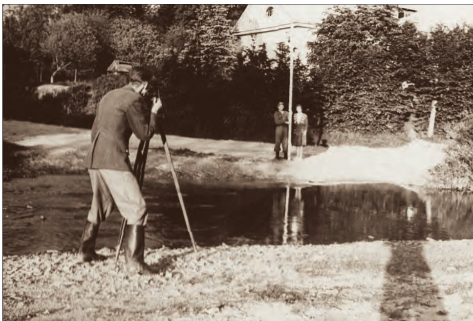
Ryc. 4. Lata pięćdziesiąte. Pomiar busolowy granic nadleśnictwa i wyląceń drzewostanowych (fot. archiwum BULiGL)
